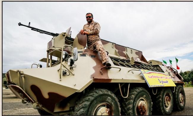
**خودروی تاکتیکی ۸\*۸ مجهر به سامانه خودکار مین ریز حیدر ۵** قابلیت حرکت در آب، خشکی و شبی را دارد و دارای درب های باز شونده و اتوماتیک با قابلیت پرتاب مین است.
