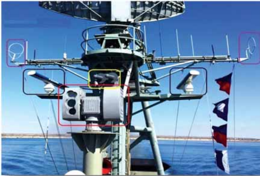
آنتن های شبیه به رادار پسیو (کادر بنفش)، رادارهای جستجوی سطحی (کادر مشکی)، آنتن اخلاگر ضد GPS/GLONASS (کادر زرد) و سامانه الکترواپتیک (کادر قرمز) منصوب بر روی ناوشکن ج.ا.ا. سهند
